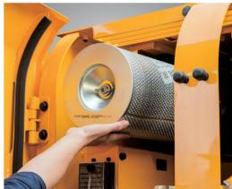
La caja de control eléctrico y el filtro de aire están centralizados en uno o el mismo compartimento para facilitar el mantenimiento.
