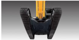
Marco de sección en caja reforzado, soldado de acero de baja tensión y alta resistencia.
