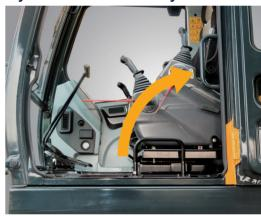
Las nuevas empuñaduras de joystick para un control preciso se han equipado con interruptores dobles.
